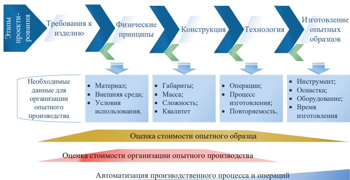
Рис. 1. Последовательность формирования необходимых входных данных для организации опытного и мелкосерийного производства изделий
