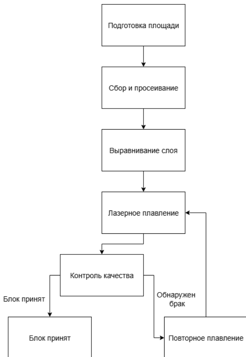
Рис. 3. Поточная линия лазерного спекания лунного грунта
